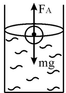
Если тело плавает в жидкости, то сила тяжести, действующая на тело, уравновешивается силой Архимеда  $m \cdot g = F_A$ .
