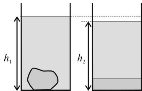
Используем отработанную схему  $V' = \frac{\rho_{\text{л}} \cdot V}{\rho_{\text{ж}}} = \frac{m_{\text{л}}}{\rho_{\text{ж}}} = \frac{m_{\text{в}}}{\rho_{\text{ж}}} > V_{\text{в}}$  (знаменатель дроби уменьшился -
