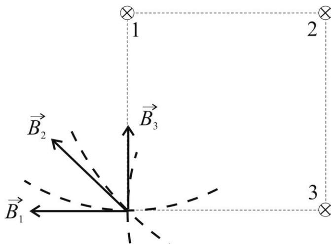
**A15.** На каждый отрезок стержня действует сила Ампера, равная  $F_{1,2} = BI l_{1,2} = \frac{1}{2} BI l$ , направление которой определяется по правилу левой руки (см. рис.). Очевидно, что результирующая сила Ампера есть
