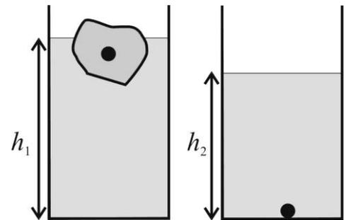
Когда тело утонет, то оно будет вытеснять объём воды, равный объёму тела  $V_2 = \frac{m_{\text{т}}}{\rho_{\text{т}}}$ .
